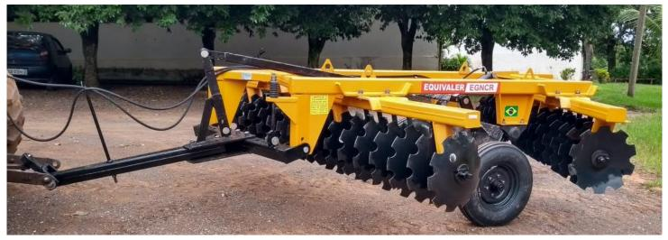
As grades niveladoras Equivaler foram desenvolvidas para trabalhar em diversos tipos de terrenos, tanto quanto planos como em declínio com a função de destorrar, nivelar e também incorporar adubos, calcário, etc. ao solo .
